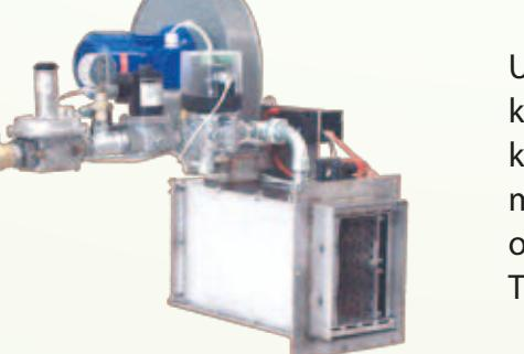
Ukoliko je u VDPE seriji, telo za sagorevanje ubaćeno unutar kanala vazduha za sušenje, ova serija ima sve komponente izvan kanala. Samo plamen i pare sagorevanja ulaze u kanal. Gorionik mora biti pričvršćen na kanal čeličnom prirubnicom, koja je obezbedjena.
