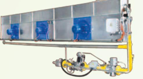
Tradicionalni gorionici sa direktnom vatrom, za vertikalne sušače. Sa ovim načinom sagorevanja, procesni vazduh za sušenje, proizведен od strane ventilatora za sušenje, vazduh za sagorevanje, proizведен od strane ventilatora gorionika i pare sagorevanja, mešaju se kako bi obezbedili vazduh pogodan za sušenje, smanjujući utrošak energije.
